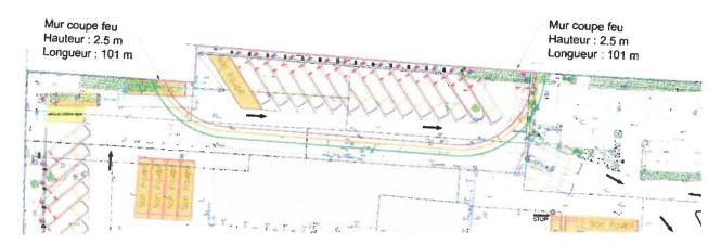
Ces postes de charge sont séparés des limites de propriété par des murs coupe-feu de degré deux heures et d'une hauteur de 2,5 m.
